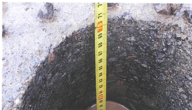
Obrázek 1 – Místo vrtané sondy VS 6 ve střední části vozovky (bez sanace podloží). Odebraný vývrt do hloubky 0,7 m dokládá asfaltové vrstvy 113 mm, recyklaci 167 mm, penetrační makadam 100 mm a podloží plastické konzistence. Ustálená hladina vody je 0,26 m pod povrchem vozovky
